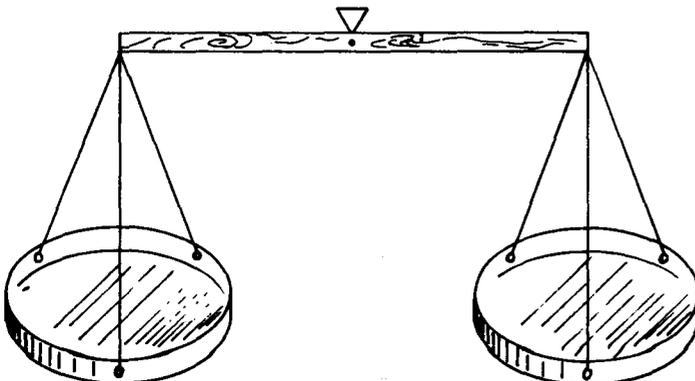
Para emplearla deben tener el cuidado de que la varilla no se incline a ningún lado sino que permanezca en dirección horizontal. El aparato así construido se denomina balanza, las tapas se llaman platillos de la balanza, la parte de la varilla que va del extremo, en donde se cuelga un platillo, al centro de la varilla se llama brazo, y como la pita para colgarla se colocó en el punto medio de la varilla, se dice que es una balanza de brazos iguales.
