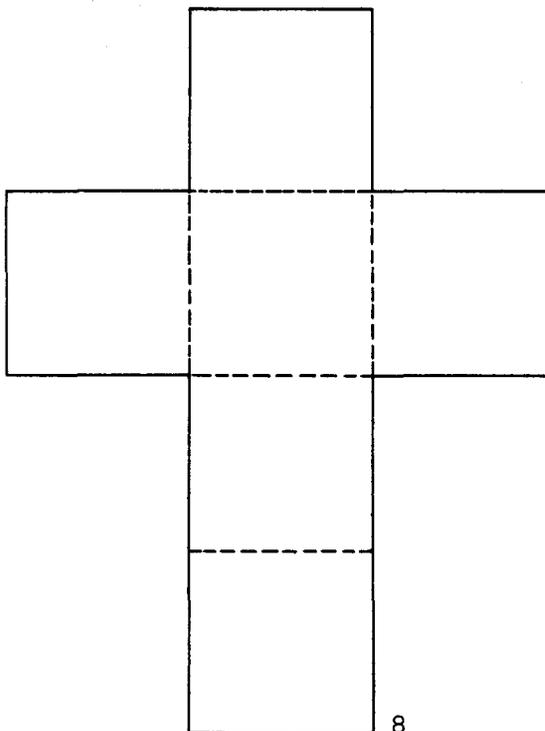
En seguida los alumnos con las tarjetas 1 y 4, pueden trazar cuatro rectángulos y dos cuadrados como se muestra en la figura, y doblar por la línea punteada para formar el modelo de prisma de base cuadrada.
